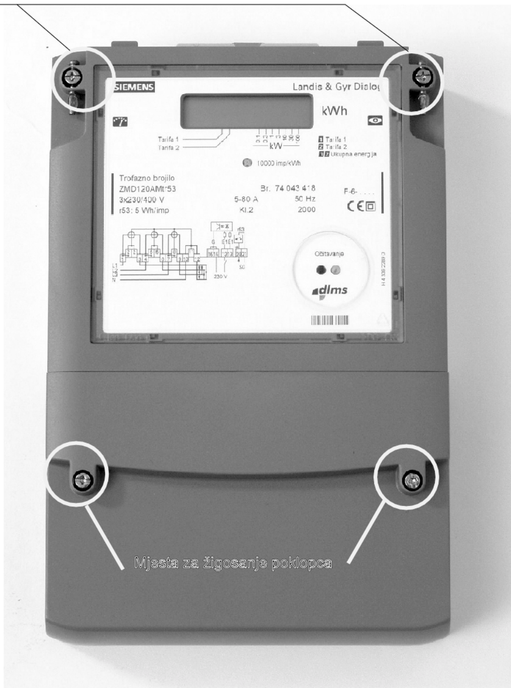
Slika 3. Izgled trofaznoga elektroničkog brojila tip ZMD 120 AM s označenim mjestima za žigosanje
